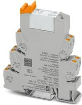
PLC-INTERFACE, per applicazioni ferroviarie composta da morsetto base con connessione Push-in e relè in miniatura a innesto con contatto di potenza, intervallo: da  $0,7 \times U_N$  a  $1,25 \times U_N$ , classe di temperatura TX: da  $-40\text{ °C}$  a  $+70\text{ °C}$ , 2 contatti di scambio, tens. di ingresso 72 V DC
