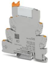
PLC-INTERFACE, per applicazioni ferroviarie composta da morsetto base con connessione Push-in e relè in miniatura a innesto con contatto di potenza, intervallo: da  $0,7 \times U_N$  a  $1,25 \times U_N$ , classe di temperatura TX: da  $-40 \text{ °C}$  a  $+70 \text{ °C}$ , 1 contatti di scambio, tens. di ingresso 24 V DC
