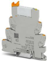
PLC-INTERFACE, composta da morsetto base PLC-BPT.../21 con connessione Push-in e relè in miniatura a innesto con contatto di potenza, per il montaggio su guida di supporto NS 35/7,5, 1 contatto di scambio, tens. di ingresso 24 V DC
