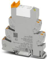
PLC-INTERFACE, per correnti permanenti elevate composta da morsetto base PLC-BPT.../21 HC con connessione Push-in e relè in miniatura a innesto, per il montaggio su guida di montaggio NS 35/7,5, corrente limite permanente fino a 10 A, 1 contatto di scambio, tens. di ingresso 230 V AC/DC
