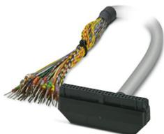
Cavo intestato; connessione 1: Fili singoli (50-poli) (I conduttori sono siglati e dotati di capocorda.); connessione 2: IDC/FLK conduttore femmina (1x 50-poli, 90 °-uscita); lunghezza cavo: 1 m
