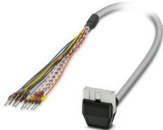
Cavo intestato; connessione 1: Fili singoli (14-poli) (I conduttori sono siglati e dotati di capocorda.); connessione 2: IDC/FLK conduttore femmina (1x 14-poli, 90 °-uscita); lunghezza cavo: 6 m
