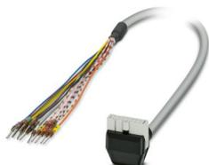
Cavo intestato; connessione 1: Fili singoli (14-poli) (I conduttori sono siglati e dotati di capocorda.); connessione 2: IDC/FLK conduttore femmina (1x 14-poli, 90 °-uscita); lunghezza cavo: 4 m
