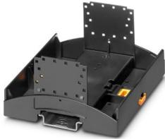
Custodia per guide DIN per l'impiego nei ripartitori di installazione a norma DIN 43880, Base custodia con piedino di fissaggio, larghezza: 107,6 mm, altezza: 89,7 mm, profondità: 48,9 mm, colore: nero (simili RAL 9005), collegamento trasversale: Connettore bus per guide DIN (opzionale), n. poli connettore trasversale: 16
