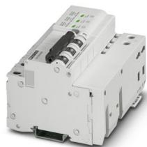
Combinazione di protezione contro le sovratensioni tipo 2 e prefusibile scaricatore, con monitoraggio dello scaricatore e del prefusibile, in abbinamento all'indicazione di stato e al contatto FM. Esecuzione: sistema a 4 conduttori (L1, L2, L3, PE), montaggio su guida di supporto NS 35
