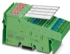
Modulo di uscita digitale Inline, completo di accessori (connettori e cartellini di siglatura), 16 uscite, 24 V DC, velocità di trasmissione 2 MBaud, connessione a 3 conduttori, numerazione standard
