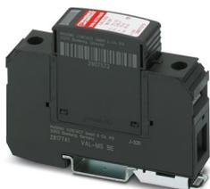
Scaricatore di sovratensioni costituito da elemento base e spina di sicurezza con varistore di potenza, per montaggio su NS 35/7.5, a 1 canale
