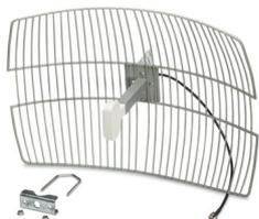
Antenna direzionale, 2,4 GHz, guadagno: 19 dBi, polarizzazione: lineare, angolo di apertura: h/v 17°/11°, grado di protezione: IP65, connessione: N (femmina), incl. supporto angolare e fascette per piloni
