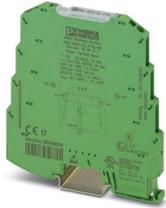
Morsetto di alimentazione MCR per l'alimentazione di più moduli analogici MINI mediante connettore bus per guida DIN, con connessione a molla, corrente d'uscita fino max. 2 A. Articolo di ricambio: 2902067 MINI MCR-2-PTB-PT.
