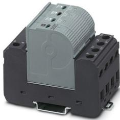
Scaricatore tipo 2 ad innesto senza corrente di dispersione (scaricatore di sovratensioni) per reti di alimentazione trifase con N e PE separato (sistema a 5 conduttori: L1, L2, L3, N, PE), con contatto FM.
