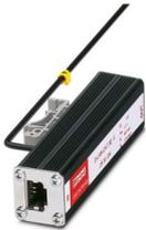
Protezione fine contro le sovratensioni secondo la Classe D (CAT.5e), per Token Ring e Ethernet. Adattatore RJ45 con linea di messa a terra separata e piedino di fissaggio per guide di supporto NS 35/7,5
