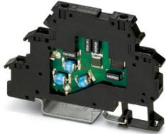
Morsetto componibile con protez. contro le sovratens. a due stadi per un filo doppio libero da potenz. di terra, connessione PE separata, tens. nomin.: 110 V AC, montaggio su NS 35/7,5, spessore morsetti: 6,2 mm, altezza: 54,6 mm
