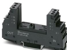
Elemento base per spina di protezione PT con circuito di protezione per circuiti di segnale a due conduttori con collegamento a terra su un solo lato. Scaricatore a gas integrato come protezione primaria tra GND e PE. Montaggio su NS 35/7,5 e NS 35/15, spessore custodia: 17,5 mm,
