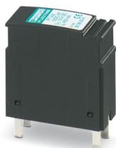
Spina di protezione PT con circuito di protez. per due circuiti di segnale a 2 fili liberi da potenziale di terra. Tensione nominale: 12 V DC. HART compatibile.
