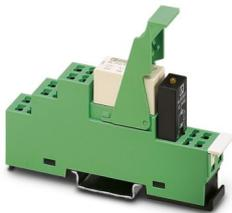
Moduli portarelè montati con connessione a molla, composti da: base relè, relè di contatto multistrato, modulo di segnalazione di stato e di soppressione dei disturbi a innesto e leva di fissaggio. Tensione d'ingresso: 24 V DC, 1 contatto di scambio, 10 A
