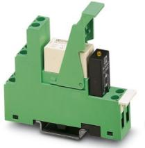
Moduli portarelè montati PR1-RSC... con connessione a vite, composti da: base relè, relè di contatto multistrato, modulo di segnalazione di stato e di soppressione dei disturbi a innesto e leva di fissaggio. Tensione d'ingresso: 120 V AC, 1 contatto di scambio, 12 A
