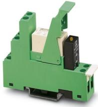
Moduli portarelè montati PR1-RSC... con connessione a vite, composti da: base relè, relè di contatto multistrato, modulo di segnalazione di stato e di soppressione dei disturbi a innesto e leva di fissaggio. Tensione d'ingresso: 24 V AC, 1 contatto di scambio, 12 A
