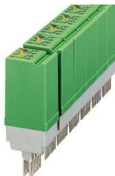
Spina a relè, equipaggiata con relè miniatura, contatti (AgNi+Au): potenze da piccole a grandi, 2 contatti di scambio, tensione d'ingresso 24 V AC/DC, con LED, innestabile su morsetti base
