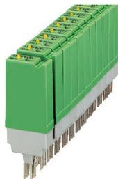
Spina a relè, equipaggiata con relè miniatura, contatti (AgPd60): Piccole potenze, 1 contatto in apertura, tensione d'ingresso 24 V AC/DC, con LED, innestabile su morsetti base
