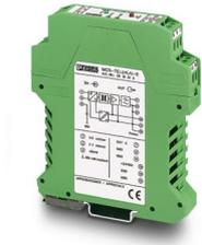
Convertitore MCR per termocoppie tipo J, K, ingresso: 0-400 °C, 0-800 °C, 0-1000 °C, 0-1200 °C, ingresso separato galvanicamente, uscita 0..10 V
