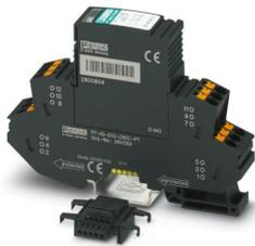
Protezione contro la sovratensione, composta da spina estraibile ed elemento base, con indicatore di stato integrato a più livelli sul modulo per due circuiti di segnale con potenziale di terra zero a 2 fili. Utilizzabile in circuiti di sicurezza fino a SIL 3.
