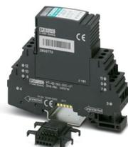
Protezione contro la sovratensione, composta da spina estraibile ed elemento base, con indicatore di stato integrato a più livelli sul modulo per un circuito del segnale libero da potenziale di terra a 2 fili. Utilizzabile nei circuiti di sicurezza fino a SIL 3.
