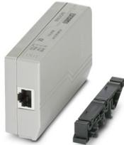
Protezione fine contro le sovratensioni per reti dati fino a 1 GBit/s. Utilizzo in Ethernet, Power over Ethernet (PoE, Mode A e Mode B), Token Ring, ISDN e DS1. Adattatore RJ45 con linea di messa a terra separata e piedino di fissaggio per guide di supporto NS 35.
