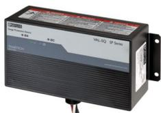
Dispositivo di protez. contro le sovratens. per configuraz. a fasi singole/ausiliarie 120/240 V AC. Utilizzo di una custodia compatta NEMA, che può essere facilmente collegata con una custodia presente. Hybrid Sine Wave Tracking offre una protezione contro le sovratensioni da 50 kA.
