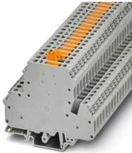
Morsetto con sezionatore a coltello, con viti per prese di prova per l'alloggiamento di spine di prova, tensione nominale: 400 V, corrente nominale: 26 A, 1. piano, tipo di connessione: Connessione a vite, Sezione di dimensionamento: 4 mm<sup>2</sup>, sezione: 0,2 mm<sup>2</sup> - 4 mm<sup>2</sup>, 2. piano, tipo di connessione: Connessione a vite, Sezione di dimensionamento: 4 mm<sup>2</sup>, sezione: 0,2 mm<sup>2</sup> - 4 mm<sup>2</sup>, montaggio: NS 35/7,5, NS 35/15, NS 32, colore: grigio
