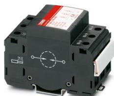
Scaricatori B tipo 1 / classe I (scaricatori di corrente atmosferica) con spinterometro incapsulato Arc Chopping, 1 canale. Larghezza custodia: 52,5 mm (3TE)
