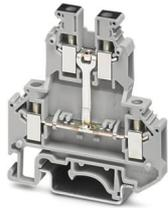
Morsetto passante a due piani, con ripartitore di potenziale, tensione nominale: 500 V, corrente nominale: 32 A, tipo di connessione: Connessione a vite, Sezione di dimensionamento: 4 mm<sup>2</sup>, sezione: 0,2 mm<sup>2</sup> - 4 mm<sup>2</sup>, tipo di montaggio: NS 35/7,5, NS 35/15, NS 32, colore: grigio
