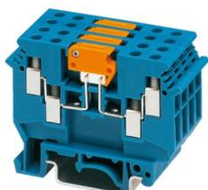
Morsetto con sezionatore a coltello, con viti per prese di prova per l'alloggiamento di spine di prova, tensione nominale: 630 V, corrente nominale: 16 A, 1. piano, tipo di connessione: Connessione a vite, Sezione di dimensionamento: 4 mm<sup>2</sup>, sezione: 0,2 mm<sup>2</sup> - 6 mm<sup>2</sup>, montaggio: NS 35/7,5, NS 35/15, NS 32, colore: blu
