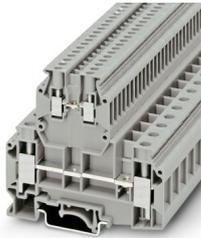
Morsetto passante a due piani, tensione nominale: 500 V, corrente nominale: 57 A, tipo di connessione: Connessione a vite, 1. piano, Sezione di dimensionamento: 10 mm<sup>2</sup>, sezione: 0,5 mm<sup>2</sup> - 16 mm<sup>2</sup>, tipo di connessione: Connessione a vite, 2. piano, Sezione di dimensionamento: 2,5 mm<sup>2</sup>, sezione: 0,2 mm<sup>2</sup> - 4 mm<sup>2</sup>, tipo di montaggio: NS 35/7,5, NS 35/15, NS 32, colore: grigio
