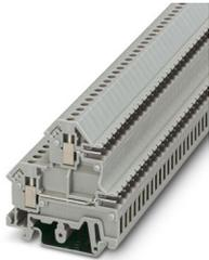
Morsetto passante a due piani, Corrente e tensione sono determinate dalla spina impiegata., tensione nominale: 250 V, corrente nominale: 10 A, tipo di connessione: Connessione a vite/a innesto, 1. e 2° piano, collegamento a sinistra, sezione: 0,2 mm<sup>2</sup> - 4 mm<sup>2</sup>, tipo di montaggio: NS 35/7,5, NS 35/15, NS 32, colore: grigio
