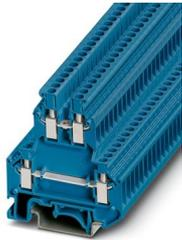
Morsetto passante a due piani, tensione nominale: 500 V, corrente nominale: 24 A, tipo di connessione: Connessione a vite, 1. e 2. piano, Sezione di dimensionamento: 2,5 mm<sup>2</sup>, sezione: 0,2 mm<sup>2</sup> - 4 mm<sup>2</sup>, tipo di montaggio: NS 35/7,5, NS 35/15, NS 32, colore: blu
