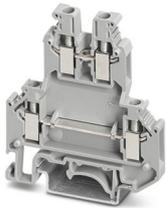
Morsetto passante a due piani, tensione nominale: 500 V, corrente nominale: 24 A, tipo di connessione: Connessione a vite, 1. e 2. piano, Sezione di dimensionamento: 2,5 mm<sup>2</sup>, sezione: 0,2 mm<sup>2</sup> - 4 mm<sup>2</sup>, tipo di montaggio: NS 35/7,5, NS 35/15, NS 32, colore: grigio
