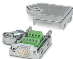
Connettore D-SUB, a 9 poli, spina, un'uscita cavo a 35°, tipo universale per tutti i sistemi, piedinatura: 1, 2, 3, 4, 5, 6, 7, 8, 9 su morsetto a vite
