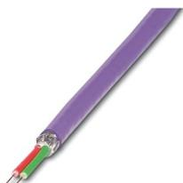
In metri, Linea di sistema bus, PROFIBUS (12 MBit/s), schermata, PVC FR VI/PVC, viola, 2-conduttori (1x2xAWG22/1), colore conduttore singolo: rosso, verde, lunghezza cavo: Ingresso libero (1,0... 1000,0 m)
