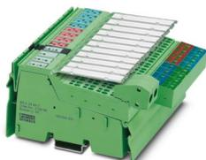
Inline, Accoppiatore bus, INTERBUS, Connettore schermato Inline, Ingressi digitali: 16, 24 V DC, tecnica di connessione: 3 conduttori, Uscite digitali: 16, 24 V DC, 500 mA, tecnica di connessione: 3 conduttori, velocità di trasmissione nel bus locale: 500 kBit/s, grado di protezione: IP20, connettori Inline e cartellini di siglatura incl.
