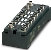
Il dispositivo bus locale ha ingressi e uscite digitali. Funzioni: 4 ingressi digitali, tempo filtro 3 ms, 4 uscite digitali ciascuna da 2 A, 500 KBd / 2 MBd commutabile, diagnostica precisa per canale, protezione da cortocircuito/sovraccarico, connes. rapida M12
