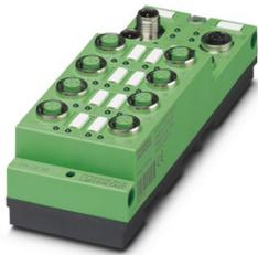
Il modulo Stand-Alone per DeviceNet™ ha 16 ingressi digitali. La connessione M12 avviene con connessione rapida. L'alimentatore 24 V DC è protetto contro cortocircuiti e sovraccarichi. La corrente nominale del modulo è pari a 1,2 A.
