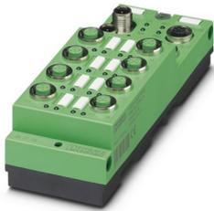
Il modulo Stand-Alone per INTERBUS ha 16 ingressi digitali. La connessione M12 avviene con connessione rapida. L'alimentatore 24 V DC è protetto contro cortocircuiti e sovraccarichi. La corrente nominale del modulo è pari a 1,2 A.
