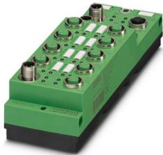
Il modulo Stand-Alone per PROFIBUS ha 4 ingressi digitali e 4 uscite digitali, con 2 A di carico ciascuna. La connessione M12 avviene con connessione rapida. L'alimentatore 24 V DC è protetto contro cortocircuiti e sovraccarichi.
