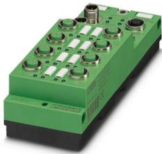
Il modulo Stand-Alone per DeviceNet™ ha 8 ingressi digitali. La connessione M12 avviene con connessione rapida. L'alimentatore 24 V DC è protetto contro cortocircuiti e sovraccarichi. La corrente nominale del modulo è pari a 600 mA.
