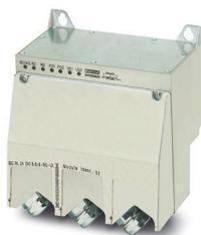
Disposit. di input/output digitale per INTERBUS; tecnol. FO con 2 MBaud, otto ingressi (24 V DC), otto uscite relè (12 V AC fino a 250 V AC, max. 2 A), conness. sens. mediante connett. femm. M12 a 5 poli, robusta custodia in metallo, grado di protez. IP67
