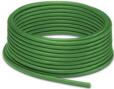
In metri, Cavo bus remoto di installazione, INTERBUS, schermata, PUR, verde pallido RAL 6017, 9-conduttori (3 x 2 x 0,22 mm<sup>2</sup> + 3 x 1 mm<sup>2</sup>), colore conduttore singolo: verde-giallo, bianco-marrone, grigio-rosa, rosso, blu, verde/giallo, posa fissa
