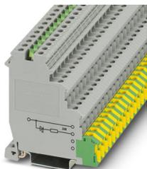
Morsetto iniziatore/attuatore, tensione nominale: 250 V, corrente nominale: 24 A, tipo di connessione: Connessione a vite, 4. piano, Sezione di dimensionamento: 2,5 mm<sup>2</sup>, sezione: 0,2 mm<sup>2</sup> - 4 mm<sup>2</sup>, tipo di connessione: Connessione a vite, 1., 2. e 3° piano, collegamento a destra, Sezione di dimensionamento: 2,5 mm<sup>2</sup>, sezione: 0,2 mm<sup>2</sup> - 4 mm<sup>2</sup>, tipo di montaggio: NS 35/7,5, NS 35/15, colore: grigio
