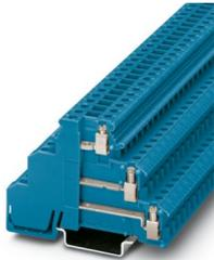
Morsetto iniziatore/attuatore, tensione nominale: 250 V, corrente nominale: 24 A, tipo di connessione: Connessione a vite, 1., 2. e 3. piano, Sezione di dimensionamento: 2,5 mm<sup>2</sup>, sezione: 0,2 mm<sup>2</sup> - 4 mm<sup>2</sup>, tipo di montaggio: NS 35/7,5, NS 35/15, colore: blu
