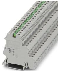
Morsetto iniziatore/attuatore, tensione nominale: 24 V, corrente nominale: 24 A, tipo di connessione: Connessione a vite, Sezione di dimensionamento: 2,5 mm<sup>2</sup>, sezione: 0,2 mm<sup>2</sup> - 4 mm<sup>2</sup>, tipo di montaggio: NS 35/7,5, NS 35/15, colore: grigio
