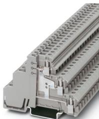
Morsetto iniziatore/attuatore, con ripartitore di potenziale, tensione nominale: 250 V, corrente nominale: 24 A, tipo di connessione: Connessione a vite, 1., 2. e 3. piano, Sezione di dimensionamento: 2,5 mm<sup>2</sup>, sezione: 0,2 mm<sup>2</sup> - 4 mm<sup>2</sup>, tipo di montaggio: NS 35/7,5, NS 35/15, colore: grigio
